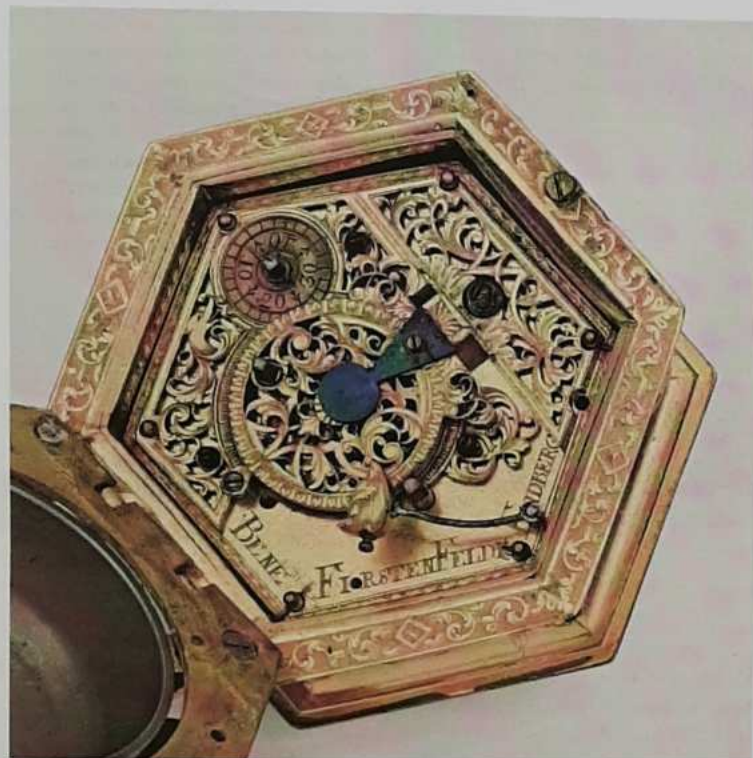
Das signierte Werk der Friedberger Horizontaltischuhr mit Spindelhemmung, Kette und Schnecke sowie Stundenschlag auf Bodenglocke und aufwendigen Dekorationen aus durchbrochen gearbeiteten und ziselierten Blattvoluten
